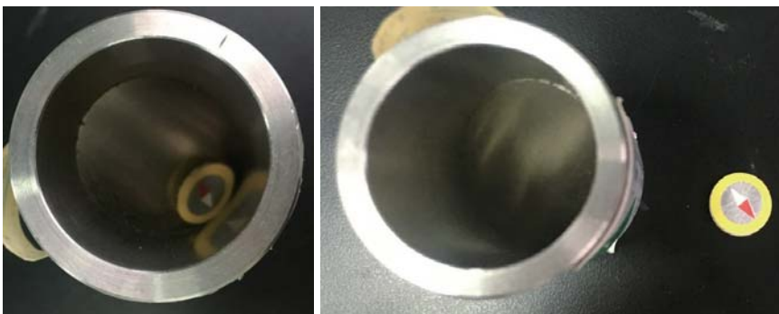
图1 拉力测试后,玩具皮带上的皮革饰件脱落,可完全容入小零件试验器
